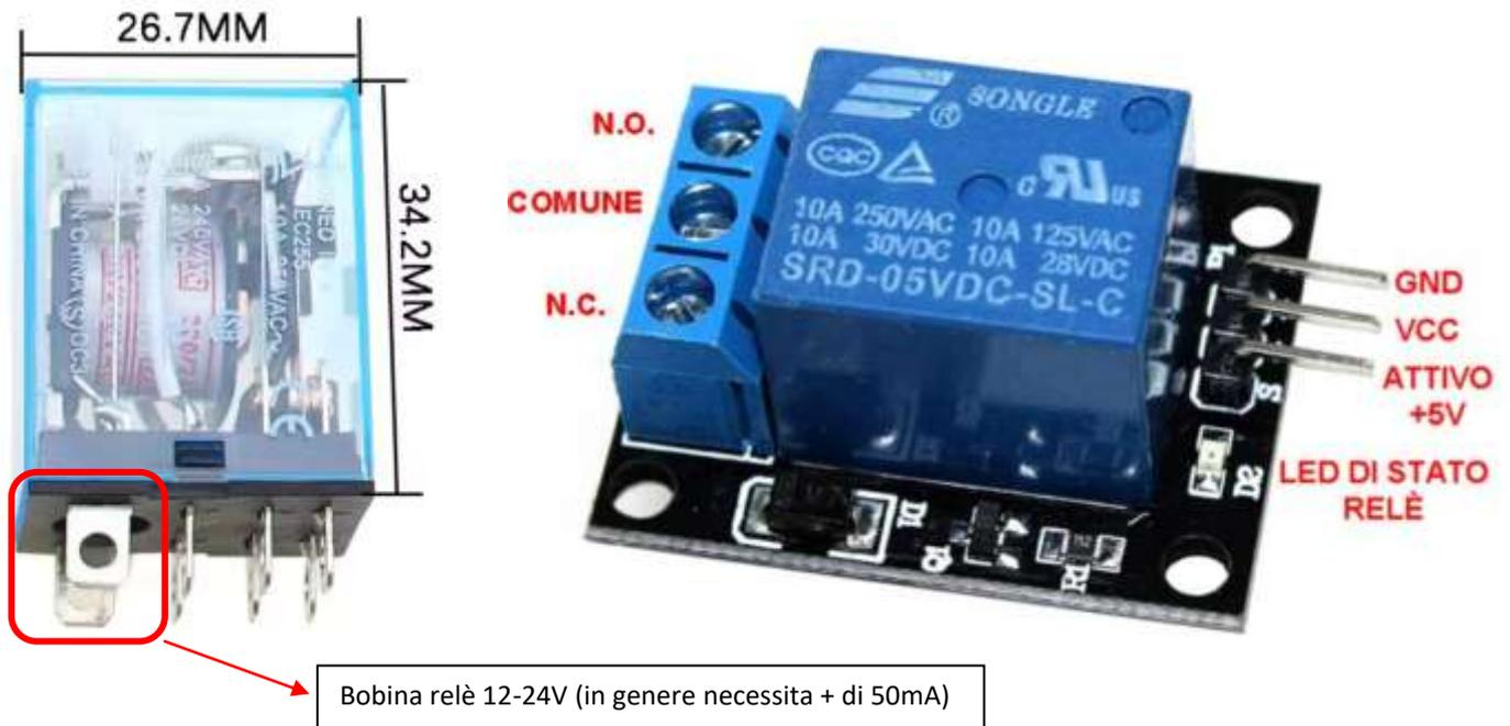
Per i microcontrollori come Arduino che in uscita ai pin possono fornire poche decine di mA sono disponibili degli shield relè (schede elettroniche) comandabili con le correnti di uscite basse (<20mA) tipiche dei microcontrollori.
