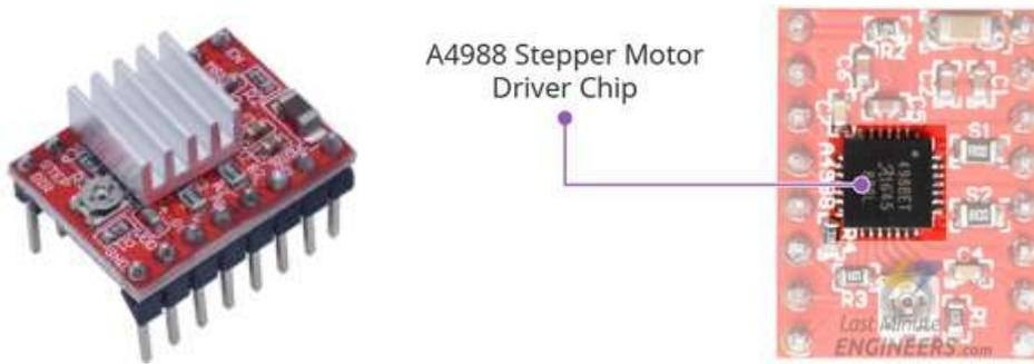
Il driver del motore passo-passo A4988 accetta in uscita fino a 35 V e  $\pm 2$  A.
