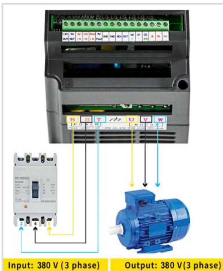
Se invece abbiamo una trifase 230V o 400V allora il VFD presenterà tre connettori R, S, T a cui collegare le tre fasi della tensione di linea.
