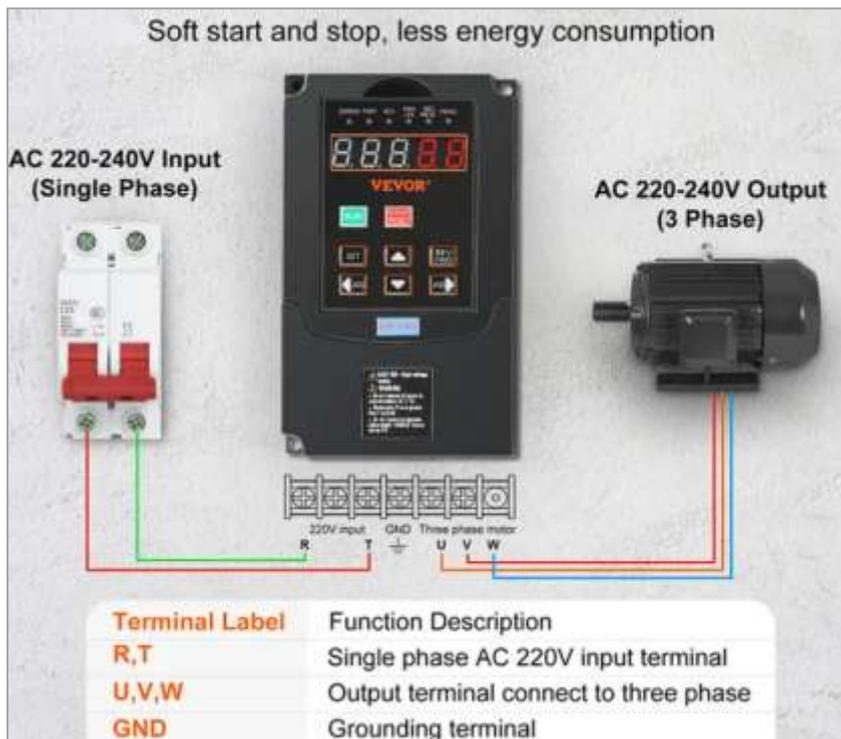
In genere (controllare sempre il manuale) se abbiamo a disposizione una tensione monofase 230V i due cavi di linea (neutro e fase) andranno collegati ai terminali R e T (l'eventuale massa alla massa GND).
