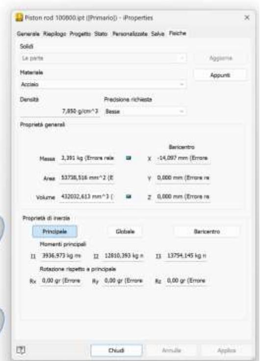
La massa complessiva movimentata da un cilindro di diametro 50mm e corsa c=80mm si trova sommando la massa del pistone-stelo, la massa del blocco di testa e la massa del punzone.
